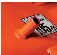
Aansluiting waterslang voor reiniging maaidek
