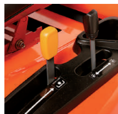
Hendel voor het hydraulisch heffen van het maaidek
